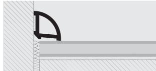
1. Scegliere il PROANGLE WOOD del colore e/o finitura legno desiderato. 2. La posa deve essere effettuata usando il silicone acrilico a fissaggio rapido, mastice, bostik, adatto per incollare PVC con malta - intonaco - pareti attrezzate ecc; oppure fissare con viti o chiodi.
