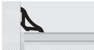
1. Scegliere il PROSEAL WOOD del colore e/o finitura legno desiderato. 2. La posa deve essere effettuata usando il silicone acrilico a fissaggio rapido, mastice, bostik, adatto per incollare PVC con malta - intonaco - pareti attrezzate ecc; oppure fissare con viti o chiodi.
